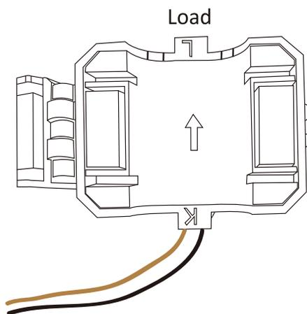
Figura 7.4 Seta Interna do Sensor de Corrente
