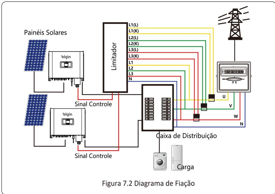
Figura 7.2 Diagrama de Fiação
