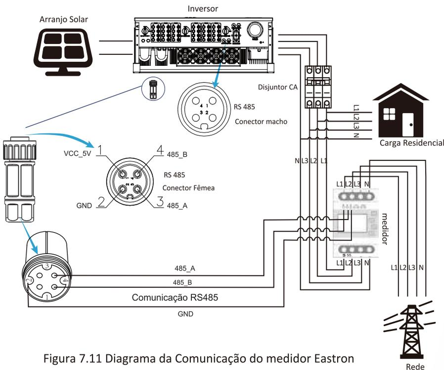
Figura 7.11 Diagrama da Comunicação do medidor Eastron
