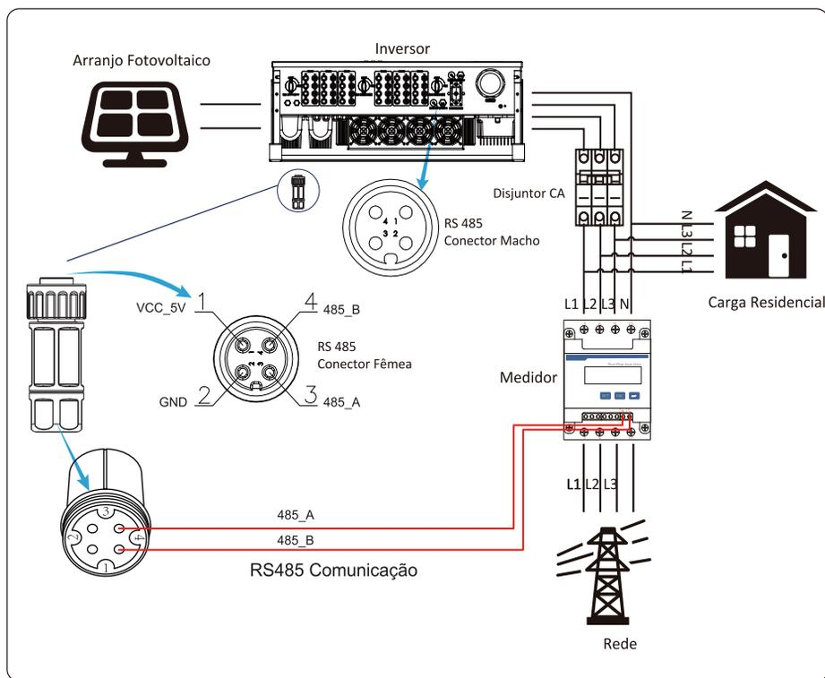
Figura 7.15 Conexão do diagrama do medidor CHINT
