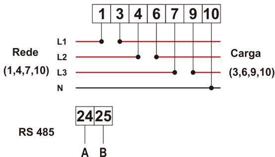
Figura 7.14 Medidor CHINT
