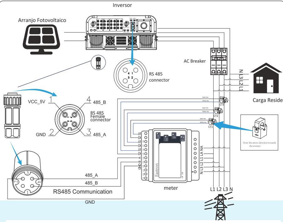
Figura 7.11 Diagrama da Comunicação do medidor Eastron
