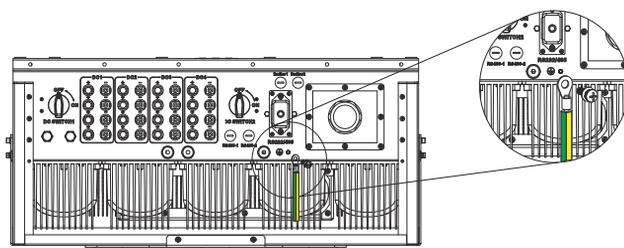
Figura 5.12 A instalação do Aterramento da Carcaça
