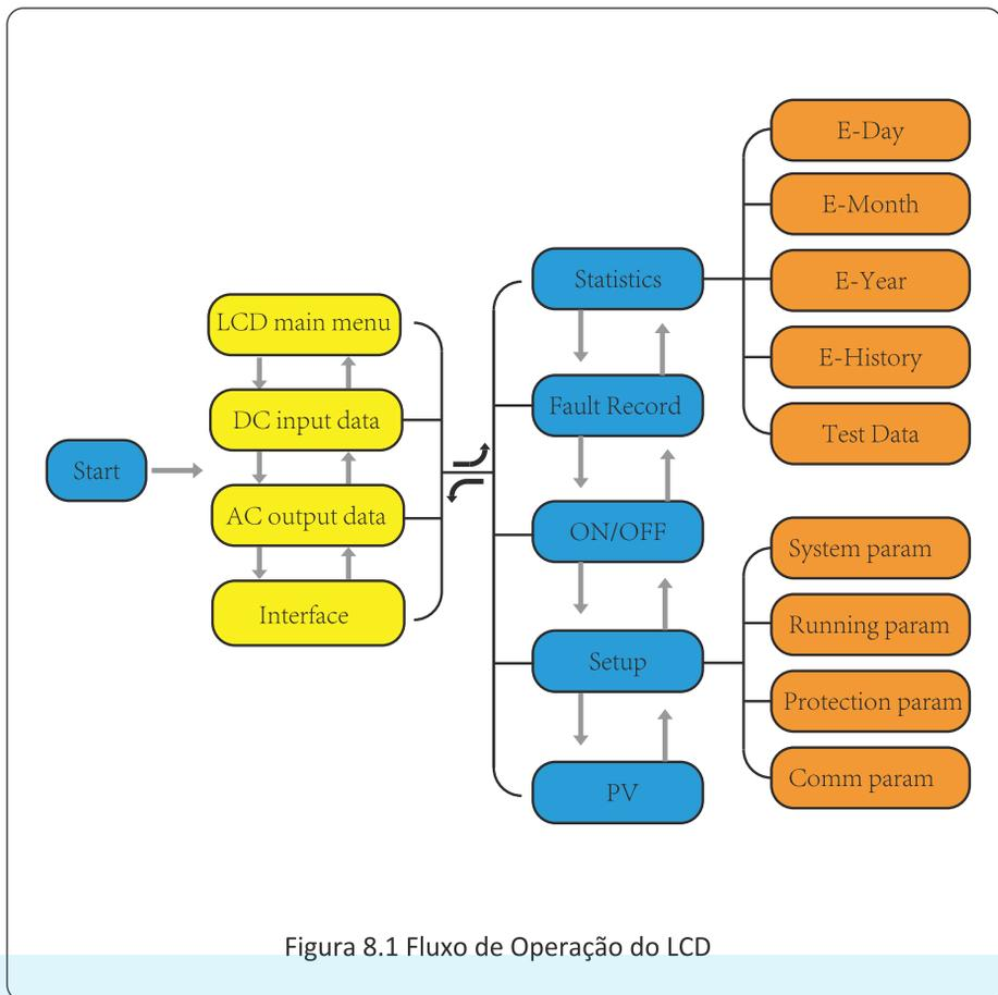
Figura 8.1 Fluxo de Operação do LCD
