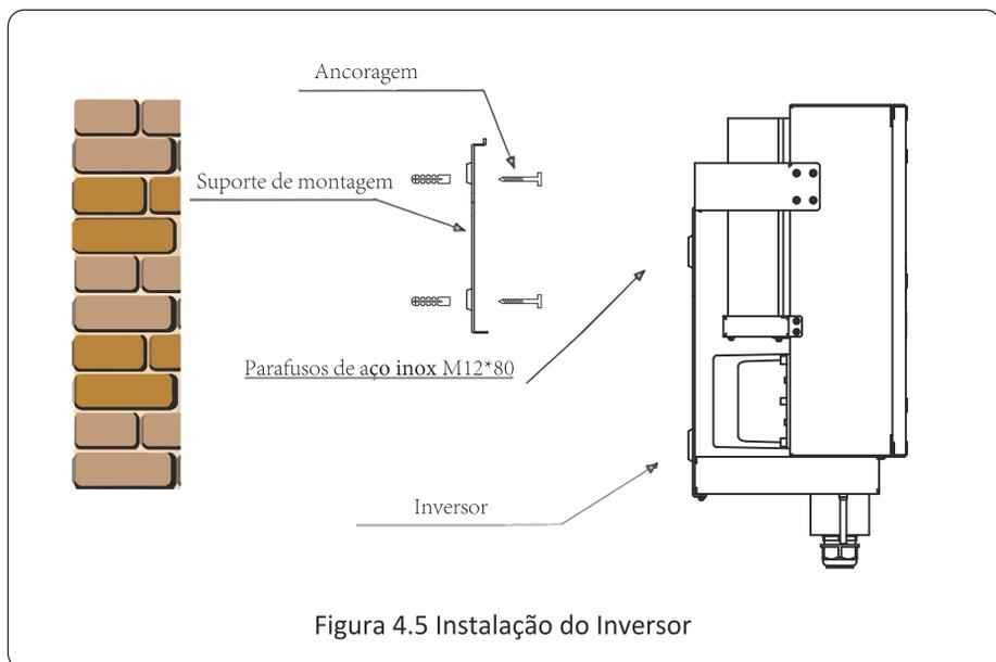
Figura 4.5 Instalação do Inversor
