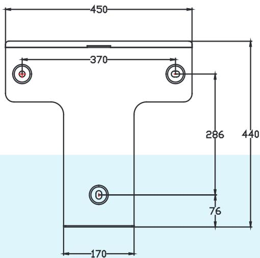
Figura 4.4 Suporte de Parede do Inversor
