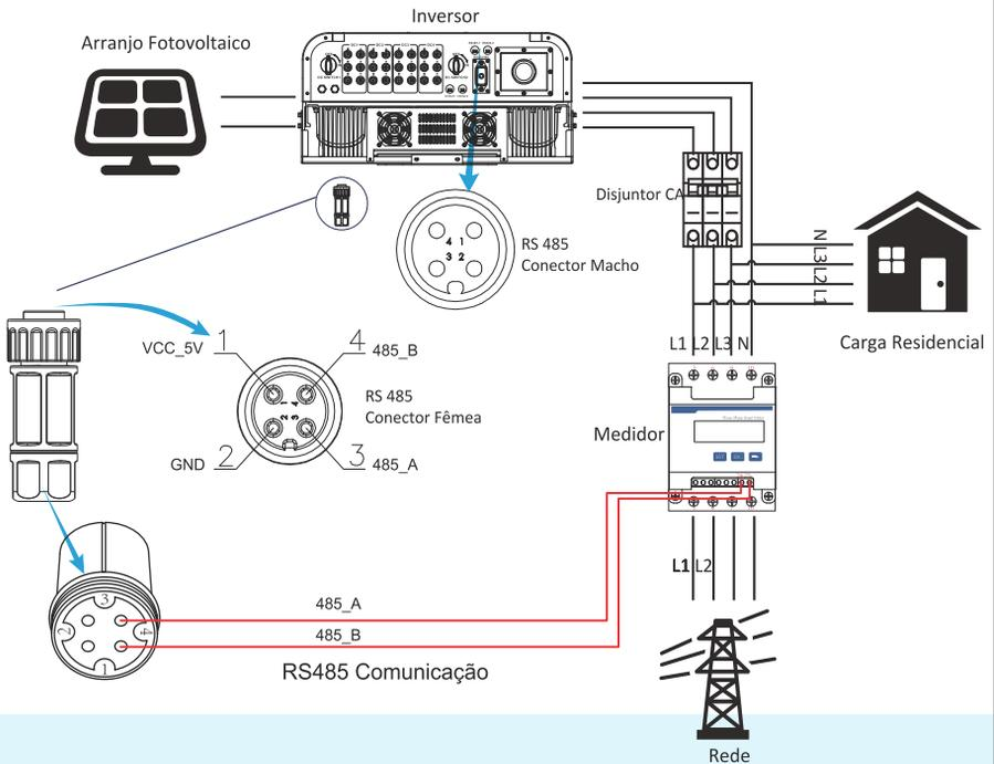
Figura 7.15 Conexão do diagrama do medidor CHINT
