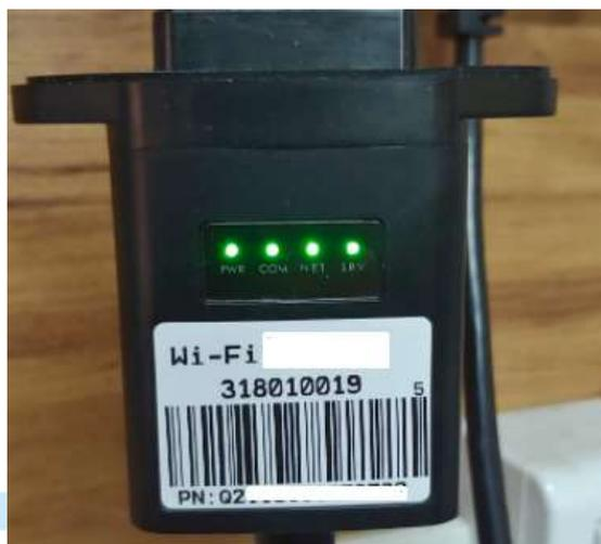
**Primeiro LED (PWR) apagado – Indica que a antena não está recebendo tensão CC**
