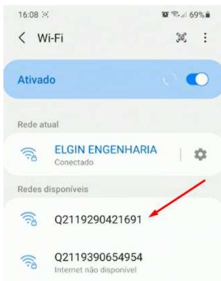
2. Após se conectar na rede gerada pelo datalogger, abra o aplicativo baixado na Pré configuração em seguida, clique na opção “Wi-fi Config”.
