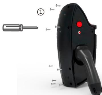
1. Use uma chave Phillips para prender levemente a tampa de vedação instalando apenas os parafusos superiores com torque de (1,5NM-2,0NM).
