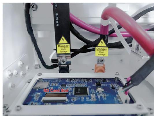
Nota: Ao inserir o cartão SD, desconecte o cabo de alimentação da bateria e gire manualmente o interruptor de ar para a posição desligado.
