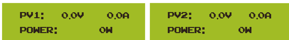
Pic 7.3 Informações sobre tensão e corrente de entrada fotovoltaica
