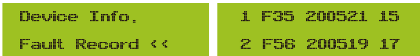
Figura 7.12 Registro de Falhas
